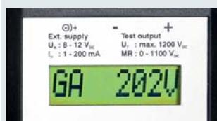
Отображение измеренного или предельного напряжения пробоя.
