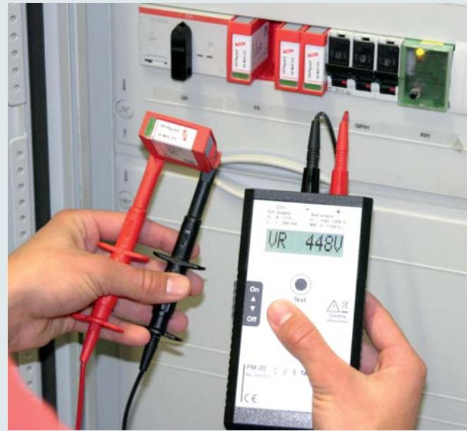
Проверка УЗИП на пробивное напряжение. Образец подключается при помощи входящих в комплект поставки контрольных щупов или специального тестового адаптера.
