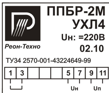
Рисунок Б.3 – Лицевая табличка ППБР-2М
