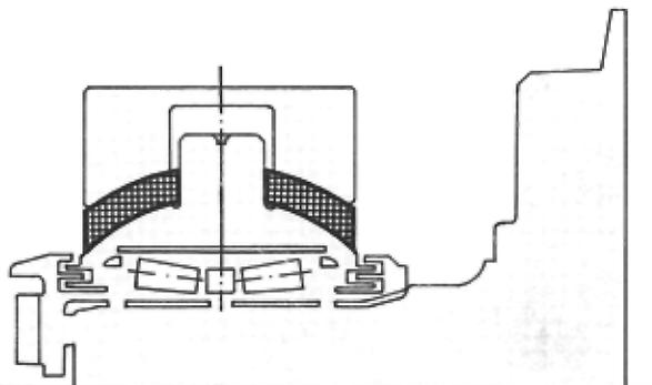
Упругая осевая опора поворотной стойки (конструкция TALBOT)
