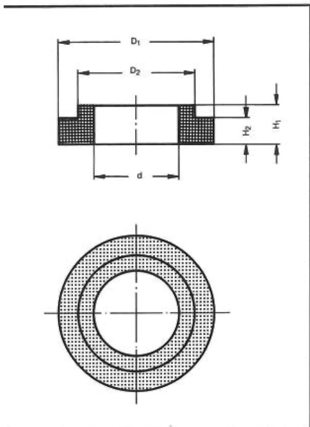
Опоры с буртом служат, например, для упругого стопорения винтов резьбовых соединений, подверженных температурным нагрузкам или вредным воздействиям окружающей среды. Кроме того, для разгрузки динамически нагруженных резьбовых соединений.
