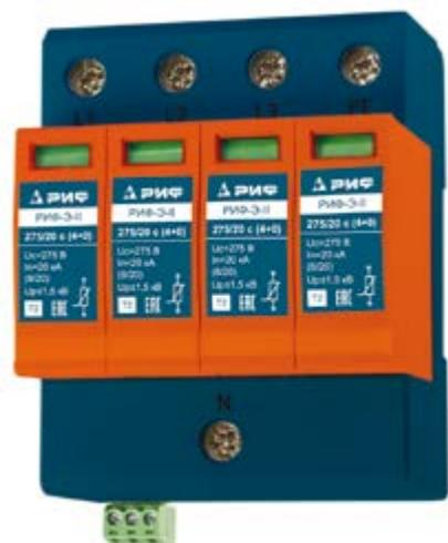
Четырехполюсное УЗИП класса II ограничивающего типа. Выполненное на базе варисторов УЗИП предназначено для организации второй ступени защиты оборудования в низковольтных цепях до 1000 В.
