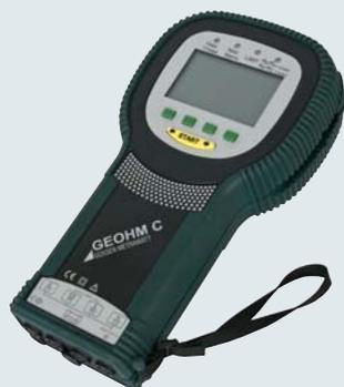
Прибор для измерения сопротивления заземления и удельного сопротивления грунта с автоматическим выбором диапазона измерений и контролем сопротивлений зонда и вспомогательного заземлителя.
