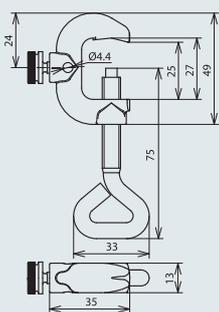
Испытательная клемма, диапазон зажима до 21 мм
