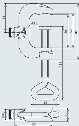
Испытательная клемма, диапазон зажима до 45 мм
