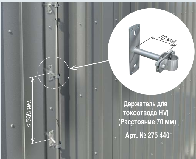
Схема – прокладка в Ex-зоне 1 или 2 и 21 или 22 на металлическом фасаде
