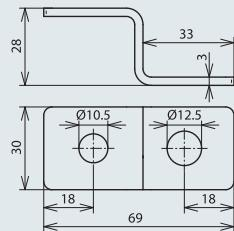
для универсального монтажа с помощью болтов с резьбой M10 и M12, например, на фиксированные точки заземления для соединения круглых проводников, например, с помощью KS-клеммы (арт. № 301 019) или для соединения с плоским проводником болтами и гайками M10 или M12
