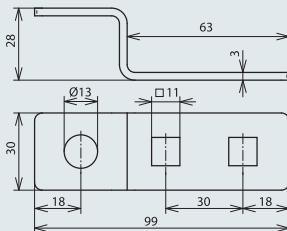
размеры 11x11 мм, для соединения, например, с помощью KS-клеммы (арт. № 301 019) или для соединения с плоским проводником болтами и гайками M10
