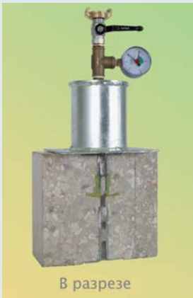
Рис. 2: Конструкция для испытания вводов под давлением
