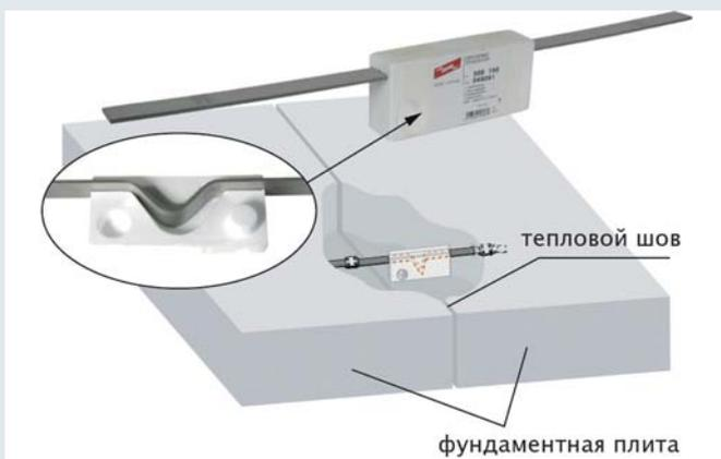
Ленточный компенсатор удлинения для прокладки фундаментных заземлителей в протяженных фундаментах (несколько участков) через арматурные швы без необходимости вывода заземлителя из фундаментной плиты
