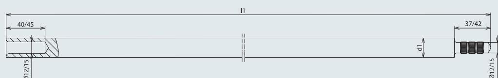
С тройной накатной цапфой (обеспечивает особо прочное на растяжение соединение)
