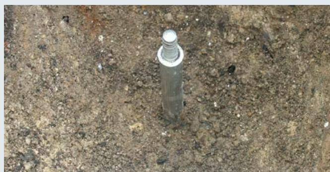
Глубинные заземлители для организации заземления токоотводов или трансформаторных подстанций
