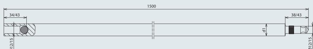
Со свинцовыми шарами в месте соединения
