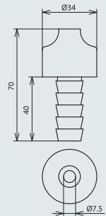
Обратить внимание при монтаже, что максимальная температура при обработке составляет +110 °C. При монтаже на высоте большей, чем 100 мм рекомендуется покрыть проходной ввод и проводник самоклеящейся уплотнительной лентой (лента alu-fix).
