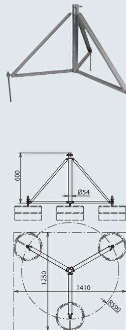
для молниеприемников D40 высотой до 5500 мм, опорных труб DEHNiso-Combi длиной 3200 мм с молниеприемником (9 бетонных опор) или токоотвода HVI, проложенного в опорной трубе длиной 3200 мм (9 бетонных опор)
