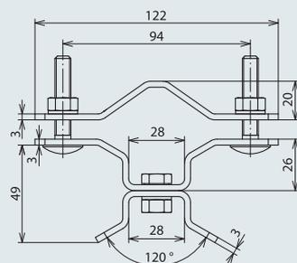
При применении крепления с помощью двух хомутов предусмотрена механическая прочность и способность нести нагрузку тока молнии до 100 кА (10/350 мкс)
