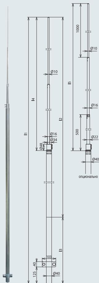
Молниеприемник для крепления, например, на стенах или других конструкциях.
