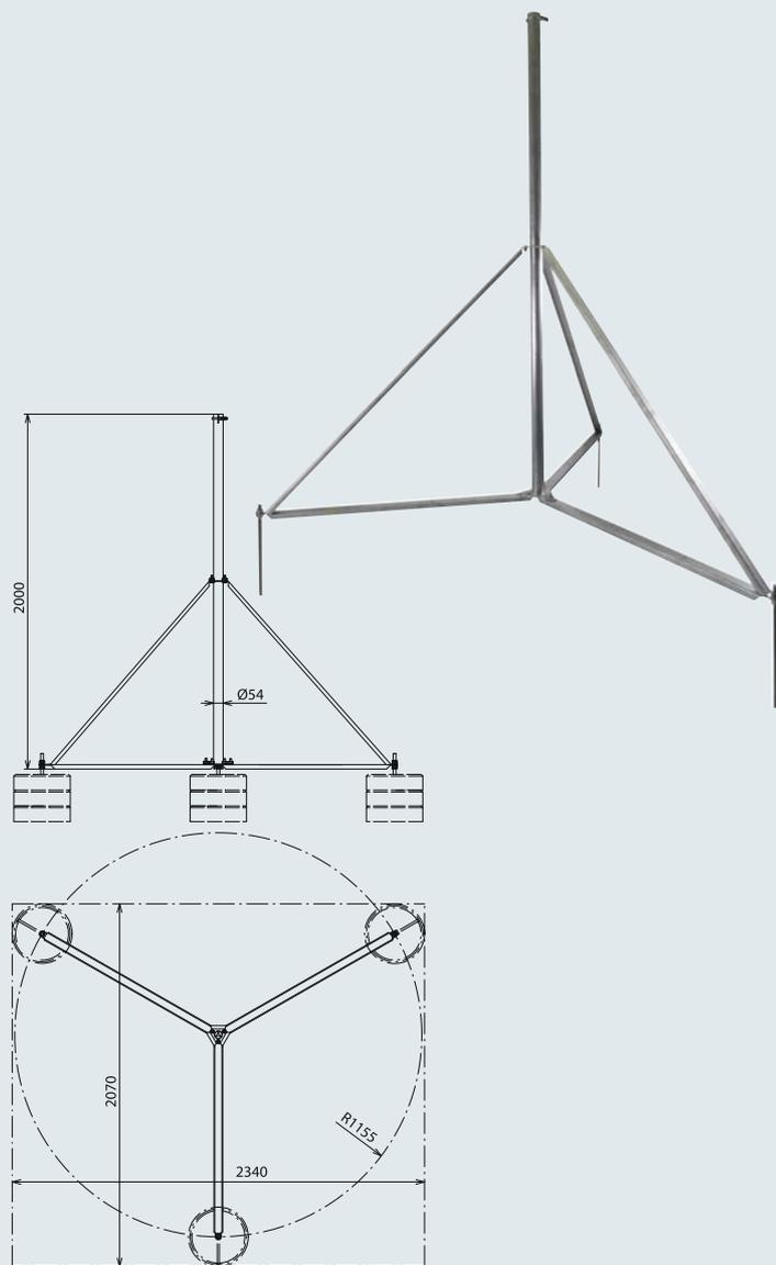
для молниеприемников D40 высотой до 8000 мм, опорных труб DEHNiso-Combi длиной 4700 мм с молниеприемником (9 бетонных опор) или токоотвода HVI, проложенного в опорной трубе длиной 4700 мм (9 бетонных опор)
