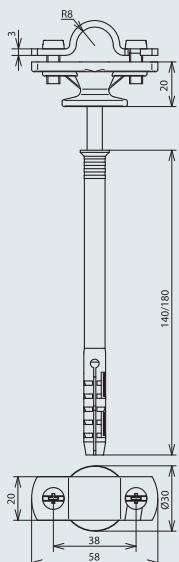
Накладка с двумя болтами M6, с фланцем (ZG) и пластиковым дюбелем Ø10 мм
