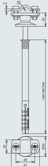
Держатель проводника для крепления проводника на стенах с теплоизоляцией
