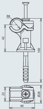
Крепежные элементы с двумя функциями (крепление держателя и крепление стержня), жесткое крепление проводника
