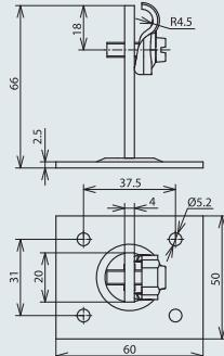
с держателем проводника DEHNQUICK, жесткое крепление проводника, высота до середины проводника 60 мм
