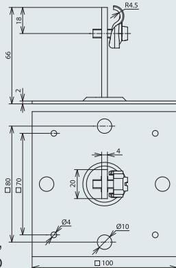
с держателем проводника DEHNQUICK, жесткое крепление проводника, высота до середины проводника 60 мм
