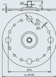
плата с болтом с резьбой M8, например, для DEHNsnap или DEHNhold при использовании на толевых кровлях, бетоне, стали и кирпичной кладке
