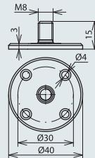
плата с болтом с резьбой M8, например, для DEHNsnap или DEHNhold при использовании на толевых крышах, бетоне, стали и кирпичной кладке
