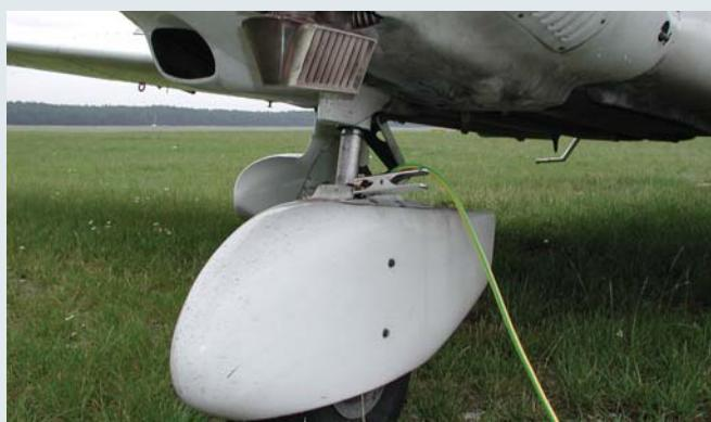
Система заземления для отводов зарядов статического электричества от цистерн, самолетов и т.п.
